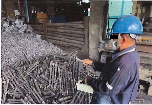
ภาพที่ 1 การสุ่มตรวจวัดสารกัมมันตรังสีในเหล็กก้อน
