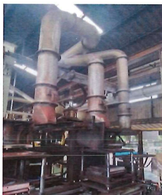
ภาพที่ 17 ระบบรวบรวมอากาศด้านบนเครื่อง shell core
