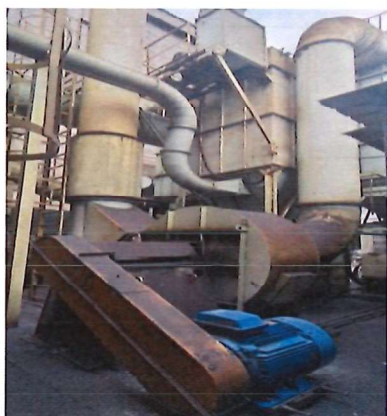
ภาพที่ 5 ปล่องระบบดักฝุ่นจาก Molding line (Line ACE)
