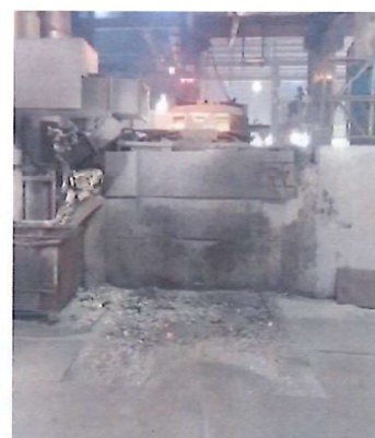
ภาพที่ 18 เตาหลอมแบบเหนี่ยวนำไฟฟ้า (เตาหลอมหลัก)
