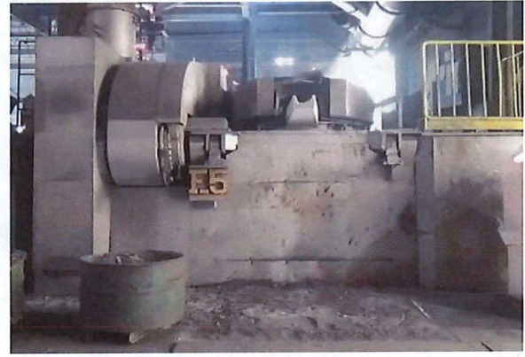
ภาพที่ 34 เตาหลอมแบบเหนียวนำไฟฟ้า (เตาหลอมสำรอง)
